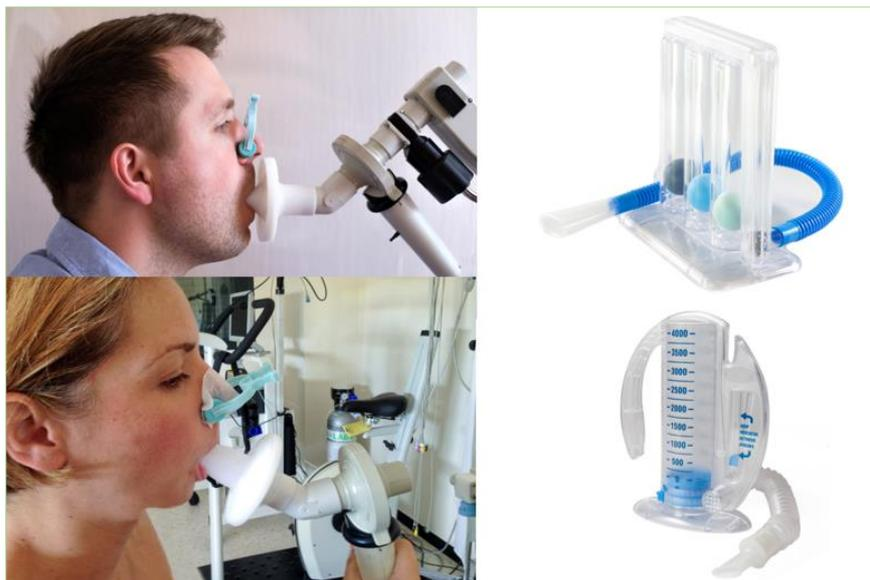
Figura 3. Ejemplos de espirómetros utilizados para las pruebas de evaluación de la función pulmonar (izquierda) y de espirómetros de flujo incentivos para inhalación de ejercicio (derecha).
